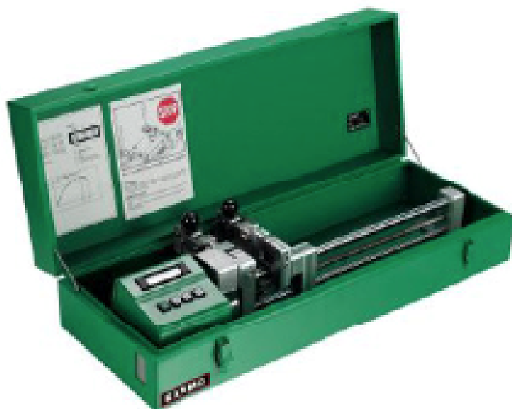
Рис. 31 Образец мини-тестовой машины для проведения испытаний на устойчивость к разрыву
