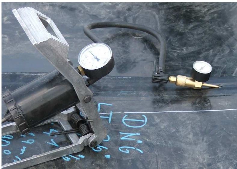
Рис.28 Тестирование давлением воздуха
