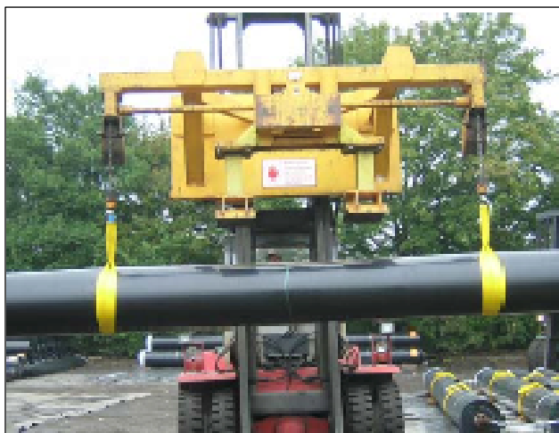
Рис.3 Погрузка с использованием ремней в открытые контейнеры
