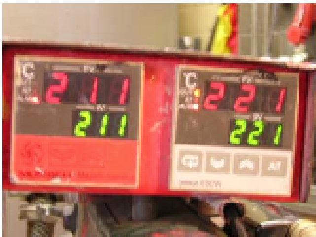
Рис.27 Стандартная температура для экструзионной сварки
