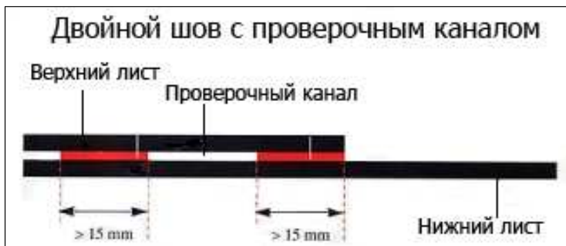
Рис.21 Двойной шов с воздушным каналом
