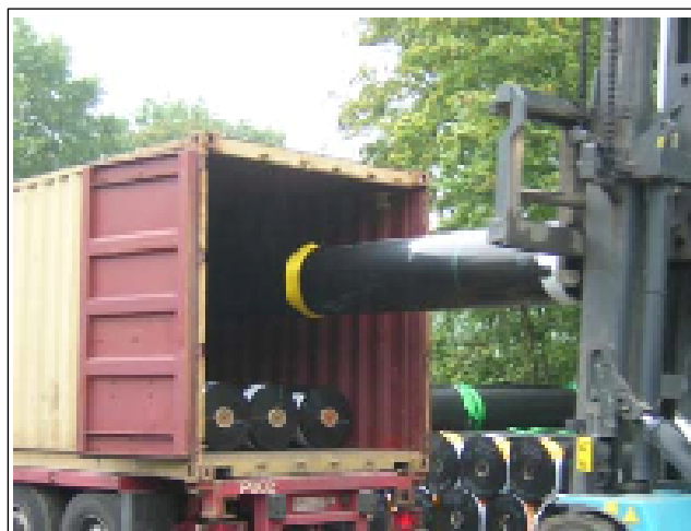
Рис.4 Погрузка с использованием погрузчика с трубной насадкой в закрытые контейнеры
